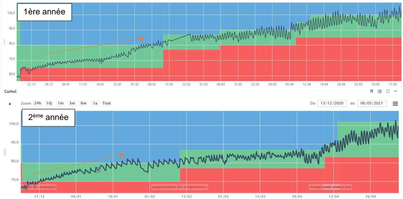
Figure 6 : Evolution de la teneur en eau des substrats : en haut substrat première année, en bas substrat deuxième année. Courbes cumulées des 3 capteurs des sondes capacitatives Drill and Drop. Extrait du site Aqualis.
