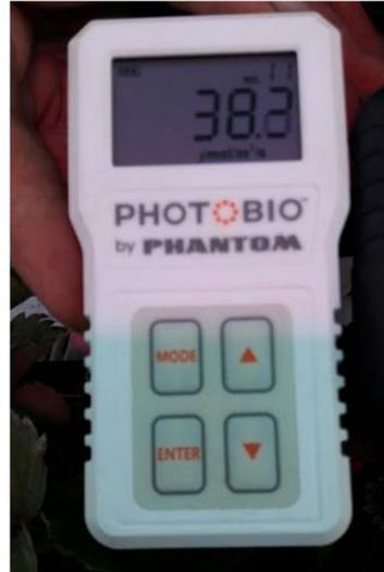
Appareil de mesure pour l'intensité lumineuse
