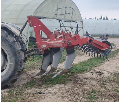
Passage sous-soleuse, une dent rabaissée
