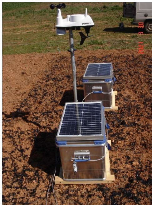
Illustration 1: Schéma conceptuel des caissons de mesure de gaz coffrets en situation
