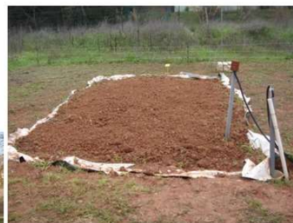
Case terminée avec piézomètre à 50 cm de profondeur et préleveur pour eaux de surface
